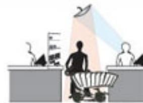
Установка над кассовым проходом обзорного зеркала предоставляет кассиру возможность в процессе работы наблюдать за происходящим в очереди и видеть содержимое корзин, тем самым предотвращая попытки краж. При таком применении зеркал снижаются потери, вызванные воровством товара в кассовом проходе, мелкого товара и краж с использованием коляски.
